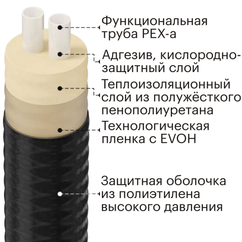
ТВЭЛ-ПЭКС-К (с армирующей системой)
